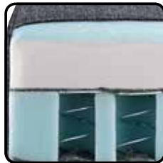
Variant 3: bonellvering i.c.m. HR-schuim (optie) Nosagveren*, onderlaag bonellvering, bovenlaag HR-schuim 38kg/m 3 , diolenwatten afdeklaag
